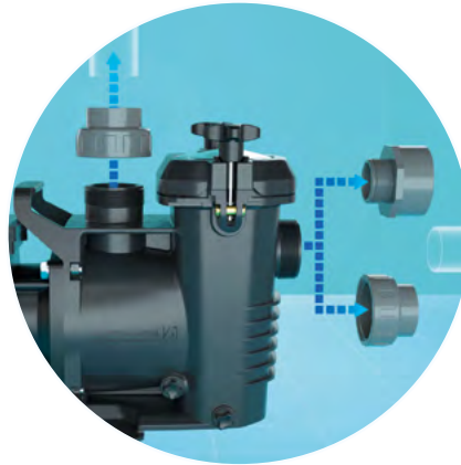
Intern 1 1/2" Gewinde Eingang Extern 2 1/4" Gewinde Ausgang, Ø50 mm
